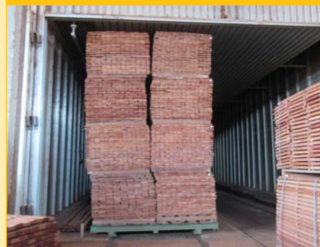
加工好的木在外部也在巨大的干燥窑内进行干燥处理。
