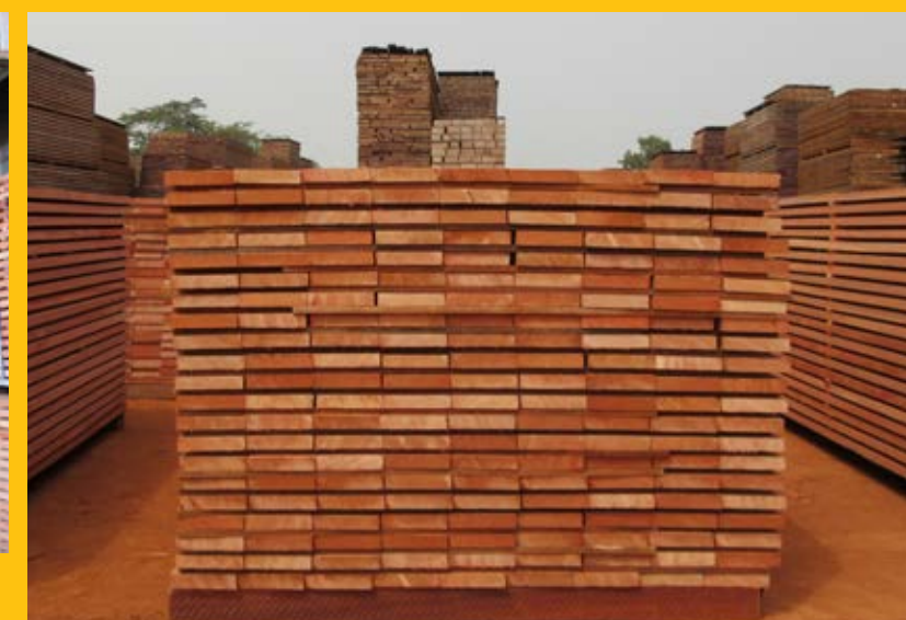
加工好的木在外部也在巨大的干燥窑内进行干燥处理。
